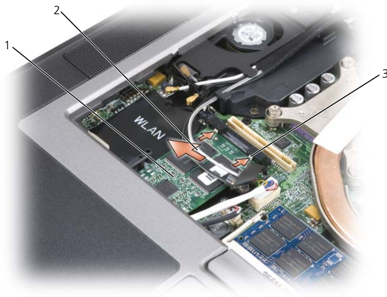
1 FCM カード 2 アンテナケーブル (2) 3 金属製固定ブラケット (2)
